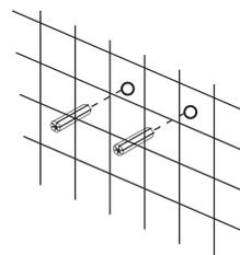
III . Прикрутите винты к стене с помощью настенных монтажных кронштейнов
